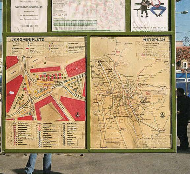
Orientierungspläne zum öffentlichen Verkehrsnetz in Graz und zum Haltestellensystem am Jakominiplatz; über den farbigen Plänen sind durchsichtige Plastikstanzen angebracht, welche die Pläne als ertastbares Relief wiedergeben und in Blindenschrift kommentiert sind. Foto: Hasso Hohmann
