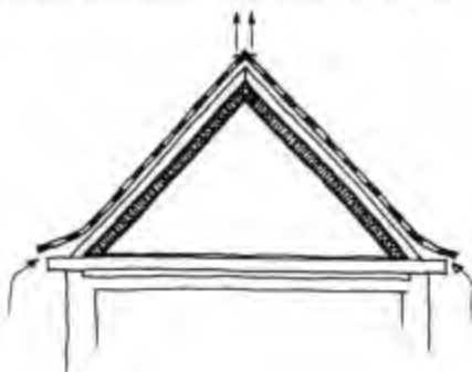
2 Ausgebautes Dach mit hinterlüfter Isolierung gegen Regen und Wärmedämmung parallel zueinander in den Dachschrägen.
